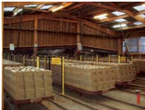
Trocknerausfahrt mit Speichermöglichkeit einer halben Tagesproduktion
