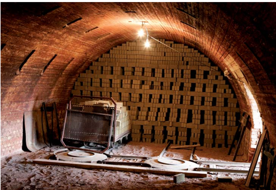
La brique de Leers est cuite au charbon dans l'un des rares fours Hoffmann encore en activité.
