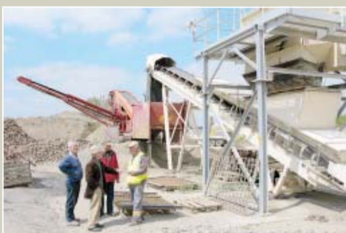
Ci-dessus, la « concasseuse-malaxeuse », une machine d'un million d'euros qui trie les matériaux. Ci-dessous, le site où sont enfouis les déchets finaux : vieilles briques et limon humide essentiellement.
