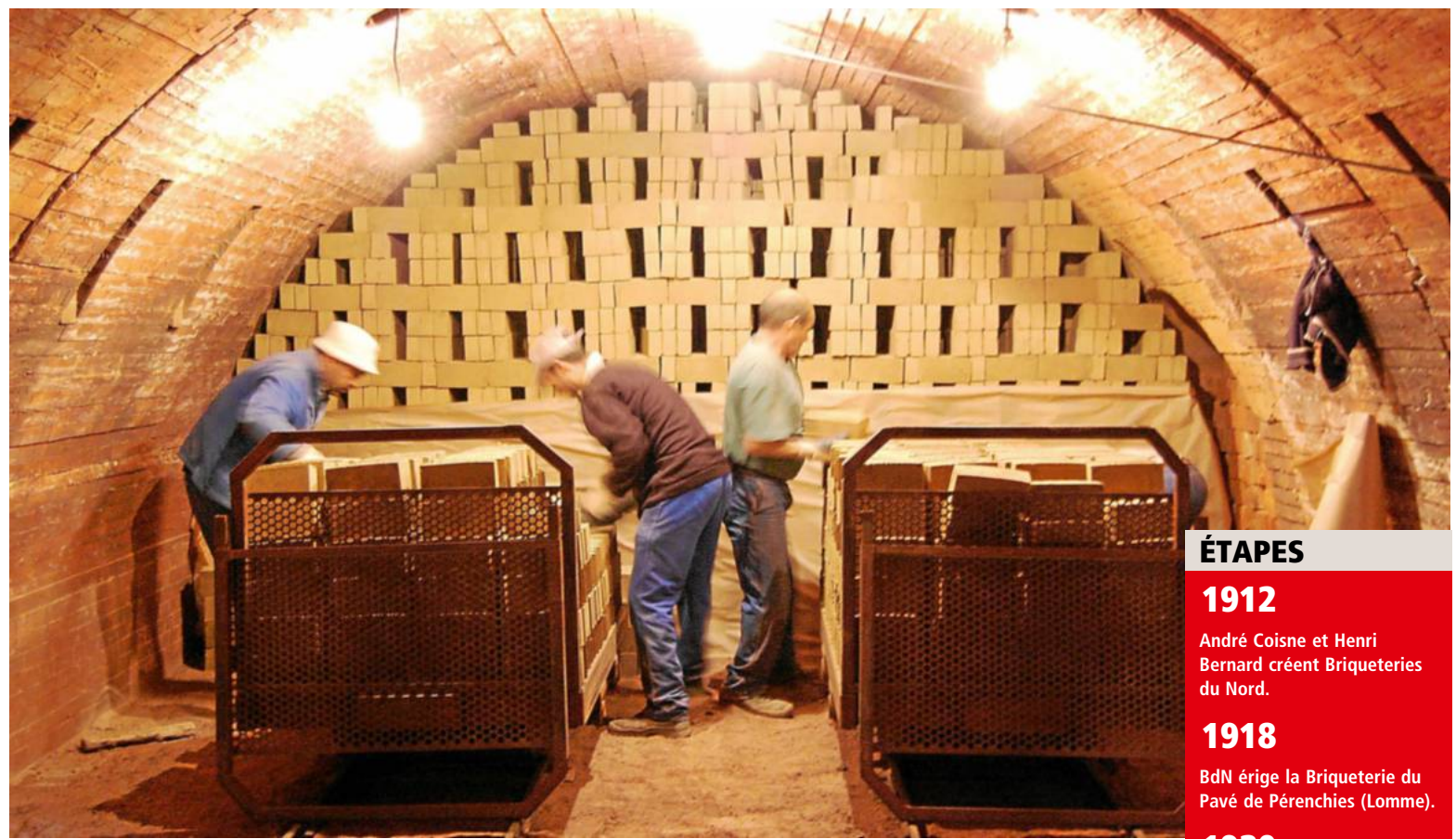
À Leers, la fabrication de la fameuse brique du Nord reste traditionnelle, dans ce four Hoffmann (jamais éteint depuis 1947 !), mais c'est bien un produit innovant que Briqueteries du Nord met en avant.
