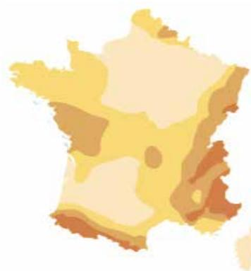
Pour le dimensionnement des bâtiments, le mouvement sismique est représenté par un spectre de réponse lié à l'accélération du sol et d'autres paramètres. Les spectres réglementaires forfaitaires dépendent de la zone de sismicité, de la catégorie du bâtiment et de la classe de sol (définie par l'arrêté) sur lequel est construit le bâtiment.
